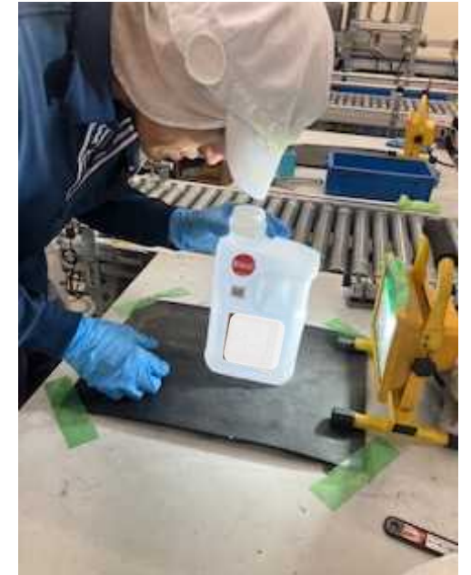
ボトル内・外面の汚れ確認 損傷の有無を目視確認
